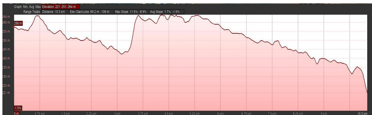
Figura 10 Profil longitudinal conducta de aductiune Lucieni – Persinari
